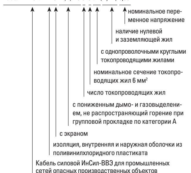
Кабель силовой ИнСил-ВВЭ для промышленных сетей опасных производственных объектов
